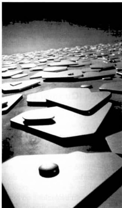
Struttura tabulare dei cristalli di alogenuro d'argento
